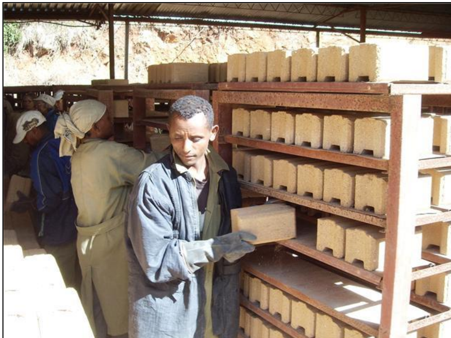
Die Erdbausteine werden zum Trocknen aufgestellt. (Bild J. Bachofner)
